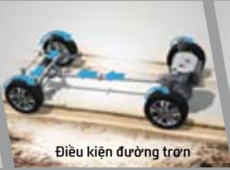
Trong trường hợp các bánh xe bị trượt Khi các bánh xe ở chế độ dẫn động cầu trước đi vào đường trơn trượt, lực kéo sẽ phân bổ xuống bánh sau tùy theo điều kiện đường.
