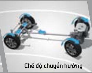
Trong trường hợp chuyển hướng Khi chuyển hướng, năng lượng được phân bổ tùy theo tốc độ xe và trục quay được chuyển xuống bánh sau.
