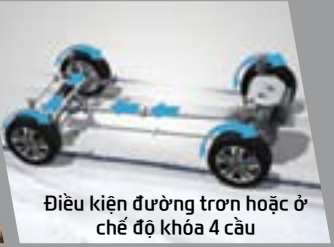
Chế độ khóa Để tối đa hóa khả năng vận hành trên những đoạn đường xấu (Được kích hoạt với tốc độ dưới 40km/giờ)
