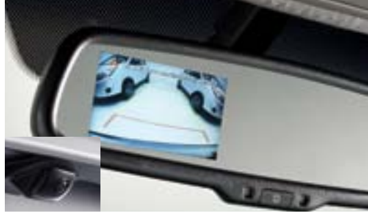
Gương điện mạ crom (ECM) tích hợp camera sau (RCD) Gương điện mạ crom (ECM) tích hợp một màn hình hiển thị hình ảnh phía sau xe, giúp việc đỗ xe hay chuyển làn trở nên thuận tiện hơn
